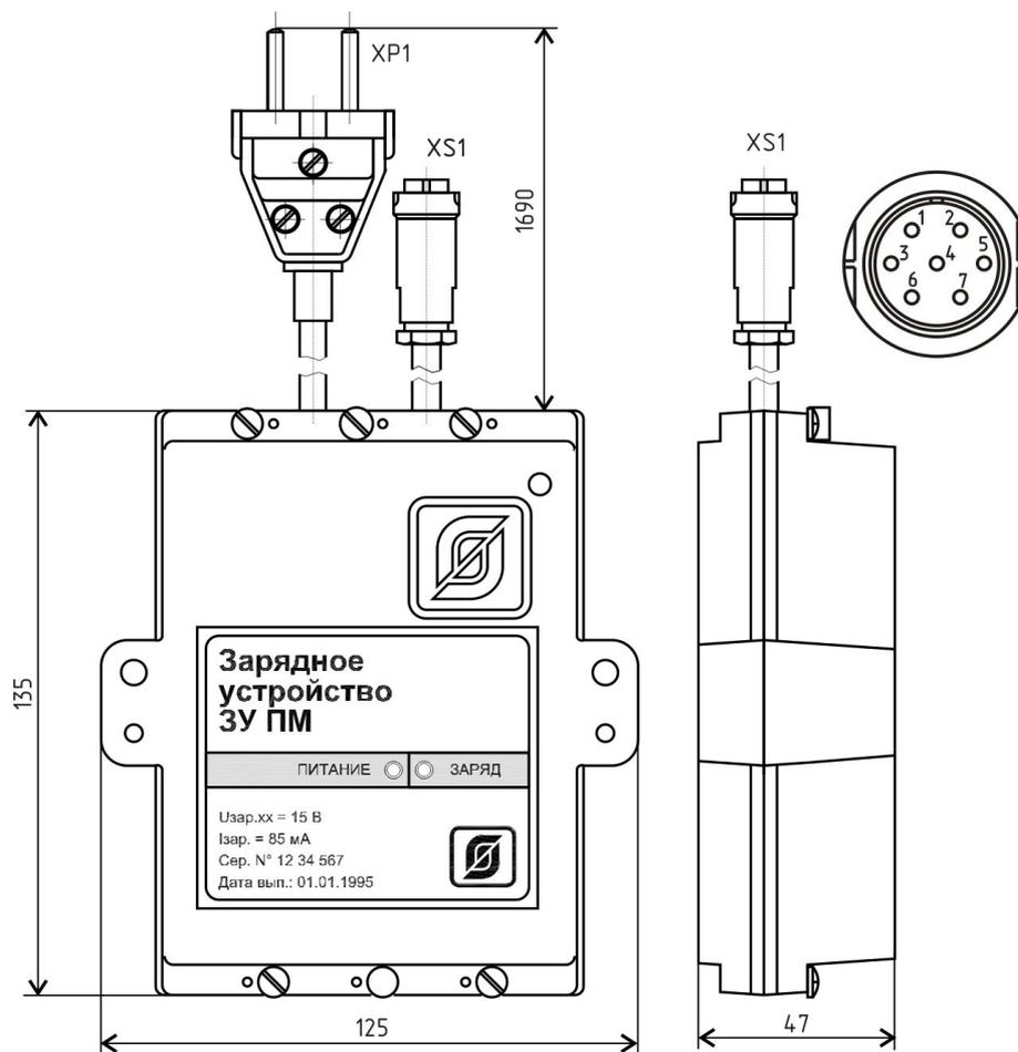
Рисунок 3 - Габаритные размеры ЗУ-ПМ
