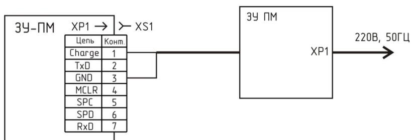
Рисунок 4 - Схема подключения ЗУ-ПМ к программатору ПМ
