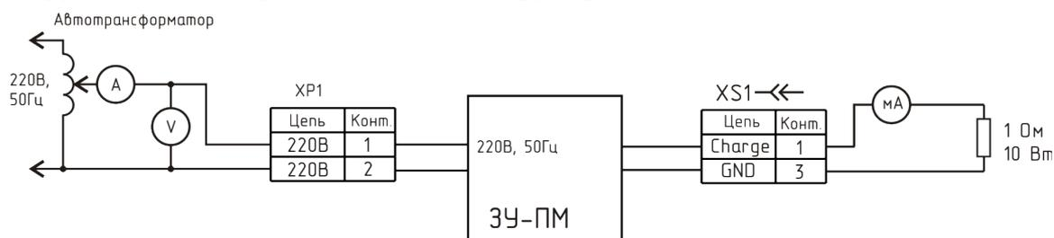
Рисунок 6 - Схема проверки величины выходного тока
