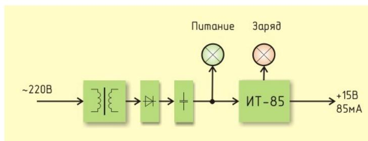
Рисунок 2 - Структурная схема ЗУ-ПМ
